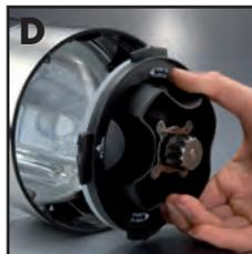
**6.** Der Messereinsatz ist mit einem Silikondichtungsrings versehen, der lose auf der Fassung des Messereinsatzes aufliegt. Nehmen Sie den Silikondichtungsrings zur Reinigung von der Kunststoffhalterung des Messereinsatzes (siehe Abb. E).
